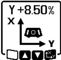
» Pour incliner l'axe Y, actionnez à nouveau la touche  $\text{L}_x\text{Y}$  sur l'outil de mesure ou sur la télécommande.
