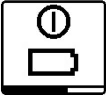
Quand l'accu ou les piles sont vides, il apparaît pendant quelques secondes un message d'avertissement et la LED d'état (12) clignote en rouge à une cadence rapide. L'appareil de mesure s'arrête ensuite.
