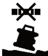
Si l'appareil de mesure est incliné de plus de 8,5 % ou positionné autrement qu'à l'horizontale ou à la verticale lors de sa mise en marche, un nivellement n'est plus possible. Il apparaît à l'écran un message d'erreur et la LED d'état **(12)** clignote en rouge.
