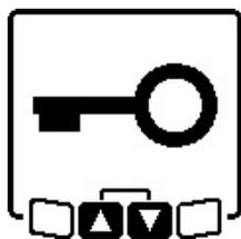
Il est possible de bloquer les touches de l'appareil de mesure et de la télécommande via l'application **Bosch Levelling Remote App**. Il apparaît alors le symbole Blocage touches sur l'écran de l'appareil de mesure.
