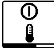
Lorsque la température d'utilisation maximale admissible de **50 °C** est dépassée, il apparaît pendant quelques secondes un message d'avertissement et la LED d'état **(12)** clignote en rouge.
