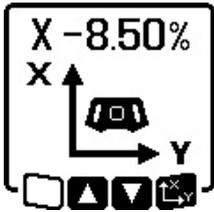
» Pour incliner l'axe X, actionnez une fois la touche  $\text{L}_x\text{Y}$  sur l'outil de mesure ou sur la télécommande.
