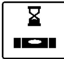
Pendant la phase d'auto-nivellement, le symbole Nivellement clignote sur l'écran. Dans le même temps, la LED d'état **(12)** de l'outil de mesure clignote en vert ainsi que la LED d'état de l'axe correspondant **((33)** ou **(34))** sur
