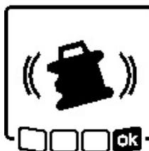
Lorsque la position de l'outil de mesure est modifiée ou qu'une forte secousse est enregistrée, la fonction d'avertissement de chocs se déclenche. La rotation du laser est stoppée et un message d'erreur s'affiche.
