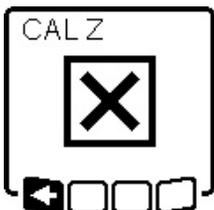
En cas d'échec du calibrage de l'axe Z, ce message d'erreur s'affiche.
