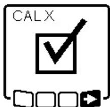
Au terme du calibrage réussi de l'axe X apparaît ce symbole sur l'écran de l'outil de mesure.
