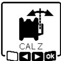
» Pour incliner le faisceau laser dans le sens ◀, actionnez la touche ▲. Pour incliner le faisceau laser dans le sens ▶, actionnez la touche ▼.
