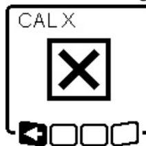
En cas d'échec du calibrage de l'axe X ou de l'axe Y, un message d'erreur s'affiche sur l'écran de l'outil de mesure. Sur l'écran de la cellule de réception apparaît **ERR**.
